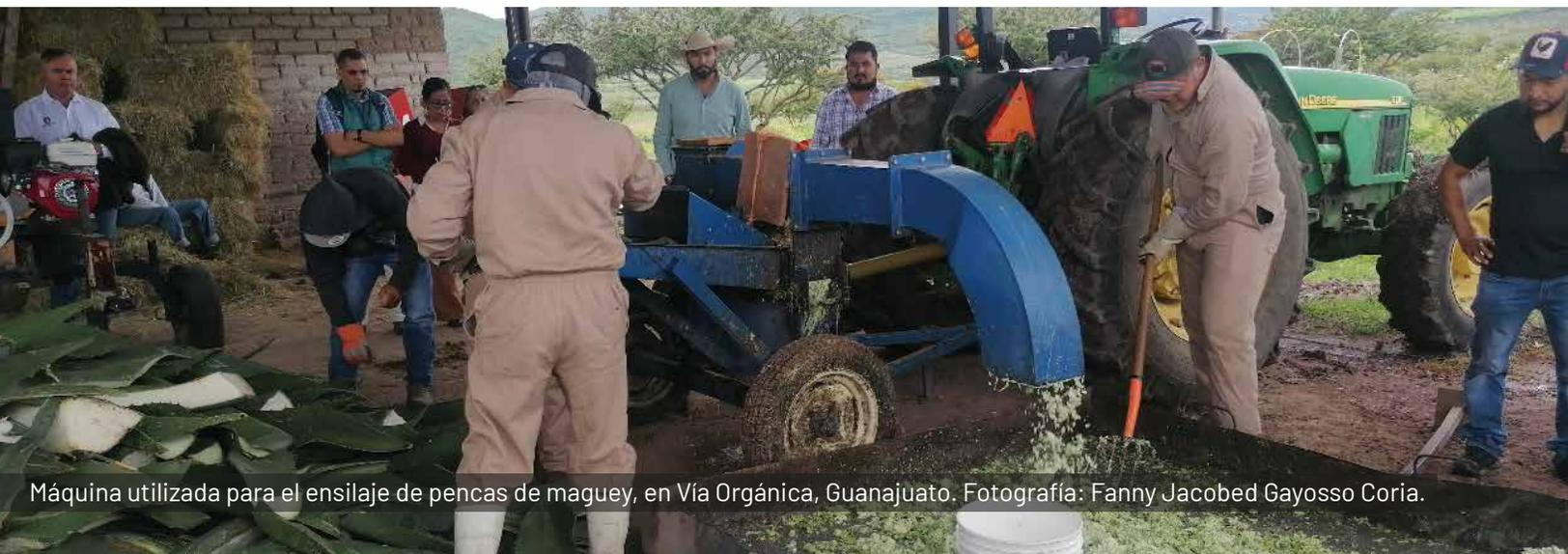
Máquina utilizada para el ensilaje de pencas de maguey, en Vía Orgánica, Guanajuato. Fotografía: Fanny Jacobed Gayosso Coria.
